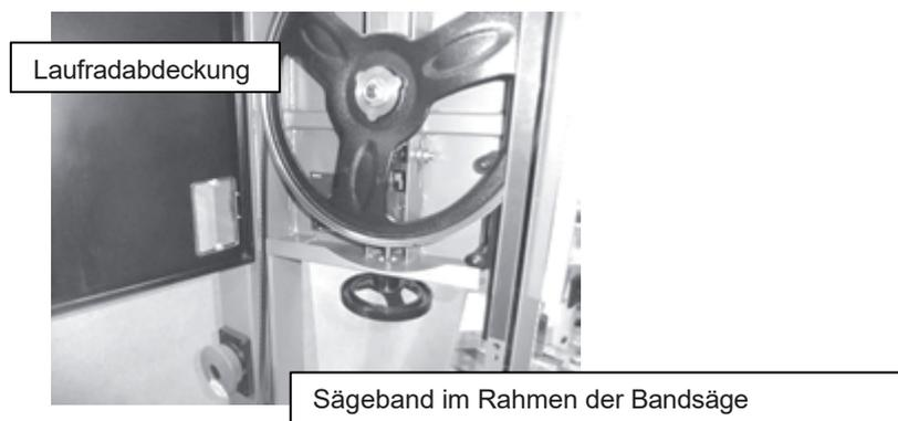
1. Um die Einstellung des Sägebandlaufs zu vereinfachen, das Laufrad in Schnittrichtung langsam drehen. Das Sägeband sollte sich selbst langsam entlang des Laufrads einstellen. Falls sich das Sägeband zu viel nach vorne oder nach hinten schiebt, kleine Einrichtung durch Einstellung der Führung auf der Rückseite der Bandsäge durchführen und dabei das Laufrad drehen. Sobald das Sägeband in der richtigen Position ist, spannen Sie es. Die Laufeinstellung verriegeln.
