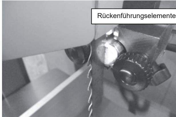
Rückenführungselemente bei Berührung des Sägebands
