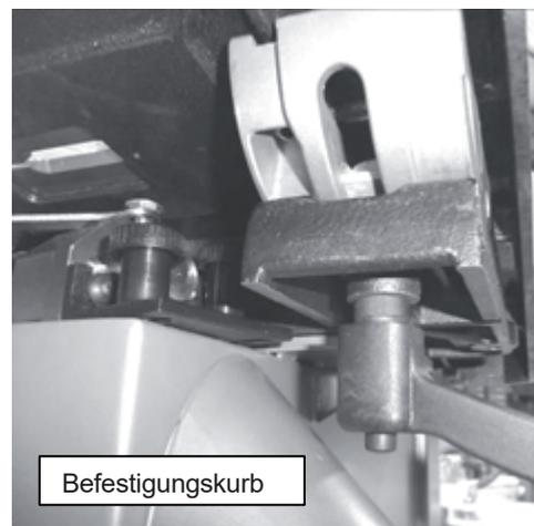
Um den Arbeitstisch in die Aufhängung zu befestigen sind zwei Sperrkurbeln zu befestigen. Die Einstellung des Arbeitstisches gegenüber dem Sägeband ist weiter in dieser Bedienungsanleitung beschrieben.
