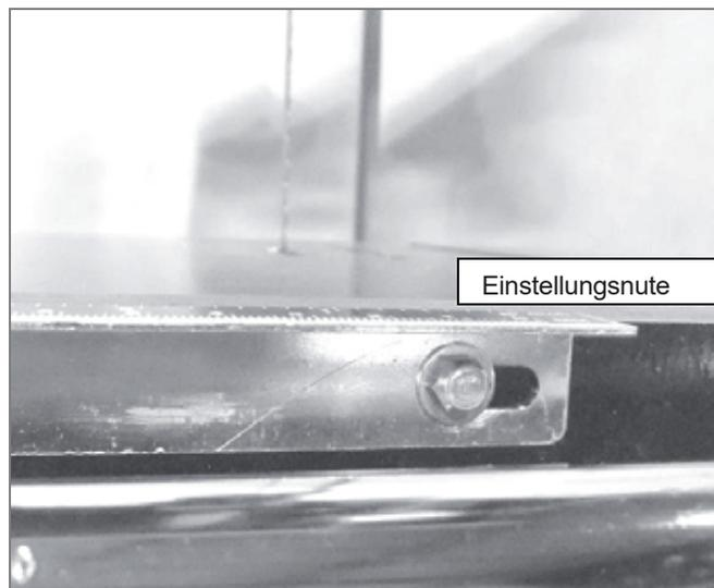
An der Tischseite befindet sich eine Skala zur Bestimmung des Abstands zwischen dem Längsanschlag und dem Sägeband. Anm.: Nach jeder Demontage des Längsanschlags muss er nach dem Wiedereinbau richtig ausgerichtet werden.
