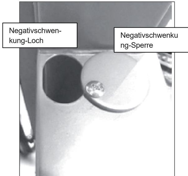
Der Arbeitstisch ist mit einer Anschlagschraube ausgestattet, um den Arbeitstisch nach Schwenkung schnell auszurichten. Die Anschlagschraube berührt die Negativschwenkung Sperre. Nach der Lösung der Negativschwenkung Sperre kann der Arbeitstisch bis in -7 Grad geschwenkt werden.
