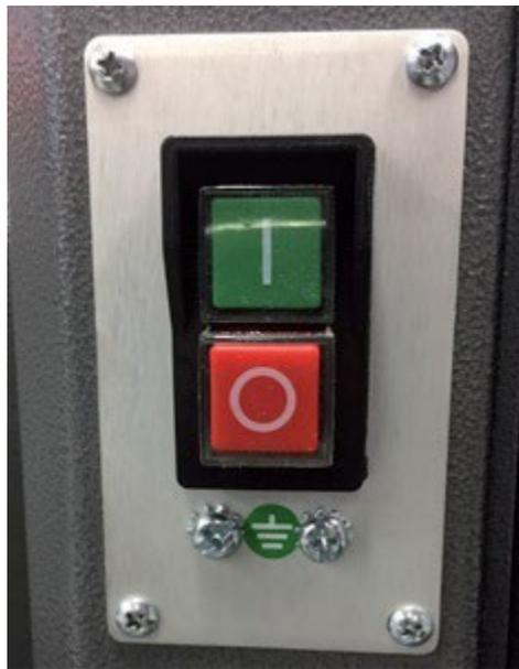
Die Bandsäge wird mit einem 230V Stecker geliefert. Der Steckdosenkreis, an den die Maschine angeschlossen wird, muss mit einem 16 A Leistungsschutzschalter, Abschaltcharakteristik C (16/1/C) geschützt werden. Durch Betätigung des grünen Schalters „I“ wird der Motor aktiviert, durch Betätigung des roten Schalters „O“ wird die Maschine ausgeschaltet.
