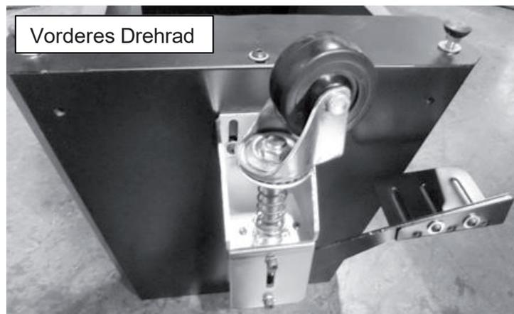
Die Erweiterung besteht aus einem vorderen Drehrad und zwei nicht beweglichen Rädern im hinteren Teil der Bandsäge.
