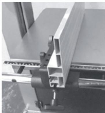
Sie können den Anschlag in zwei Positionen verwenden (horizontal und vertikal). Die horizontale Position ist für das Schneiden von schmalen Werkstücken geeignet, mit dem Anschlag in vertikaler Position wären ähnliche Schnitte gefährlich und schwer auszuführen. Der Anschlag in vertikaler Position ist optimal für das Schneiden von hohen Werkstücken.
