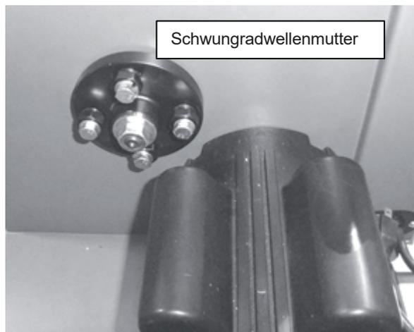
Um den Antriebsriemen auszutauschen, muss das untere Laufrad entfernt werden.
