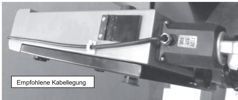
Das Licht wird am Oberteil der Bandsäge gemäß Abbildung montiert. Das Licht ist mit einem 230V Stecker ausgestattet. Das Kabel ist so zu legen, dass es sich auf keinen Fall in der Nähe des Sägebands oder der Schranktür befindet. Empfohlene Kabelführung ist auf der Abbildung dargestellt. Verwenden Sie Kabelklemmen, um das Kabel entlang des Oberteils der Bandsäge zu befestigen. Vergewissern Sie sich, dass das Kabel nicht über dem Loch im Oberteil der Bandsäge geführt wird.
